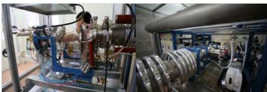
画像6・7:AORIに導入された、放射性炭素年代測定用のシングルステージ加速器質量分析計
